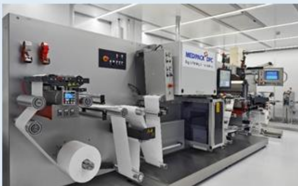
Digitaldruckmaschine mit integrierter Stanze
