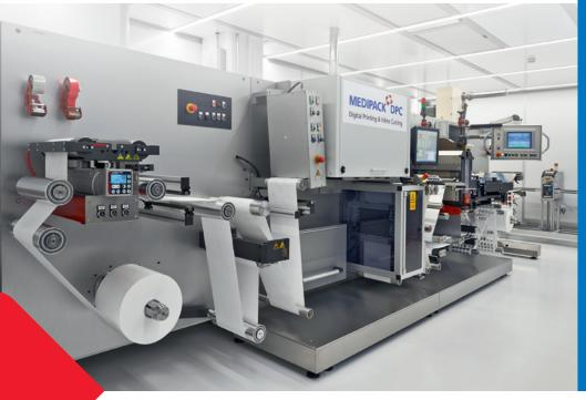
Nous réalisons sur notre machine d'impression numérique à poinçon intégré, dans des conditions de salle blanche, les points suivants :
