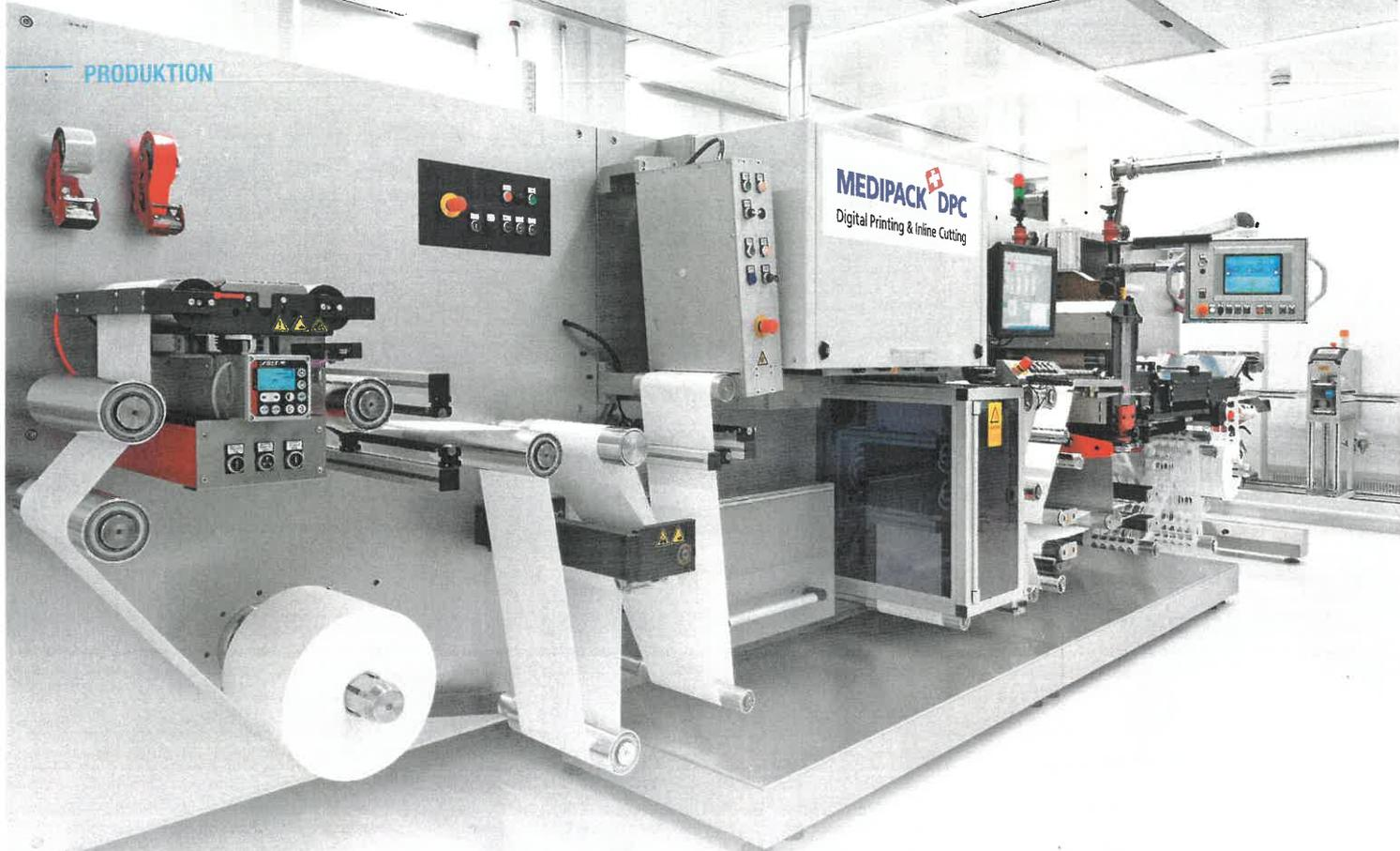
Der Digitaldruck wird in einem Reinraum CleanCell4.0 der Reinraumklasse ISO 8 durchgeführt.
